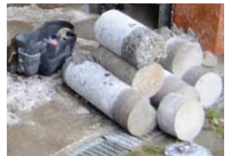
Die Bohrkern werden fachgerecht entsorgt.
